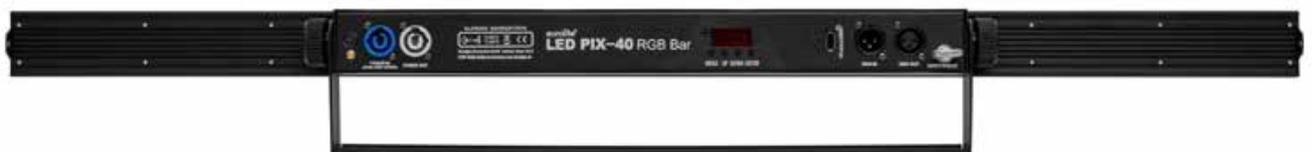
Die PIX-40 RGB-Leiste ist 100 Zentimeter lang und professionell verarbeitet. Auf der Rückseite befinden sich P-Con-Ein- und -Ausgänge für den Strom sowie dreipolige XLR-Buchsen. Zusätzlich verfügt das Gerät über eine USB-Buchse für drahtloses DMX, nutzbar mit dem EUROLITE Quick DMX oder dem Futurelight CRMX USB-Empfänger. Da die Bar lüfterlos arbeitet, erzeugt sie keinerlei Geräusche und kann auch in sehr geräuschempfindlichen Umgebungen problemlos eingesetzt werden.
