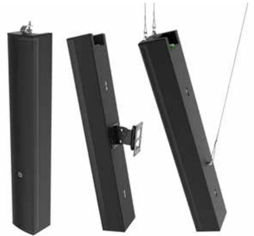
Für die Anschlussmöglichkeiten bietet der Lautsprecher duale parallele Speakon-kompatible Anschlüsse sowie einen 5,0-mm-4-Pin-Schraubklemmenanschluss (2x2 parallel). Bei den Montageoptionen stehen verschiedene Möglichkeiten zur Verfügung: 75 mm VESA-Halterung (hinten), ein M10-Befestigungspunkt (oben) und drei M6-Befestigungspunkte sowie zwei Schlitz-Montageplatten für die bündige Wandmontage.
